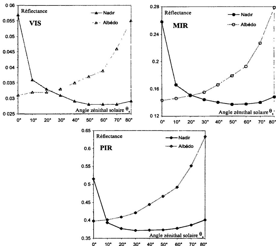
**Figure 4.** Influence de l'angle zénithal solaire  $\theta_s$  ( $0^\circ$  à  $80^\circ$ ) sur l'albédo et la réflectance au nadir VIS, PIR et MIR d'une forêt tropicale. L'estimation de l'albédo avec la seule réflectance au nadir peut conduire à de fortes erreurs.
