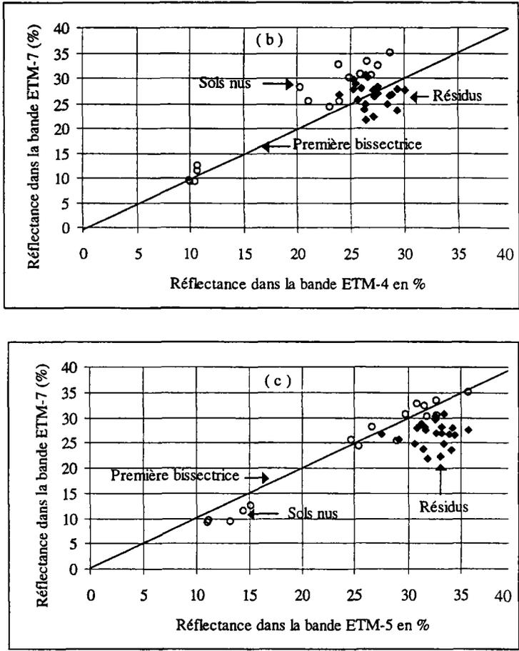
**Figure 2.** Représentation des réflectances des sols nus et des résidus de soja et d'orge : (a) dans l'espace spectral ETM-5 / ETM-4, (b) dans l'espace spectral ETM-7 / ETM-4 et (c) dans l'espace spectral ETM-7 / ETM-5
