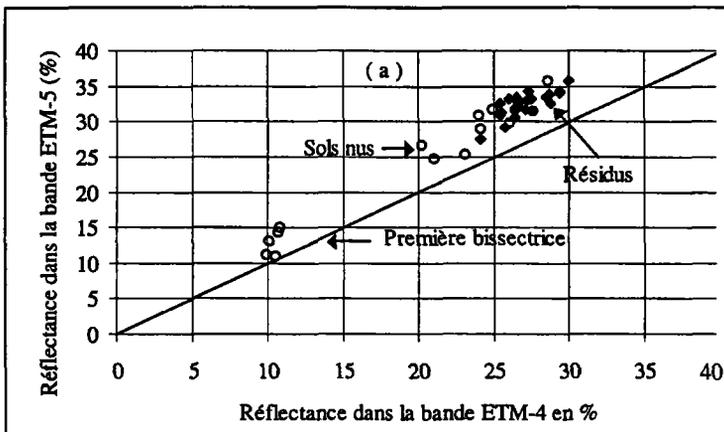
**Figure 2.** Représentation des réflectances des sols nus et des résidus de soja et d'orge : (a) dans l'espace spectral ETM-5 / ETM-4, (b) dans l'espace spectral ETM-7 / ETM-4 et (c) dans l'espace spectral ETM-7 / ETM-5
