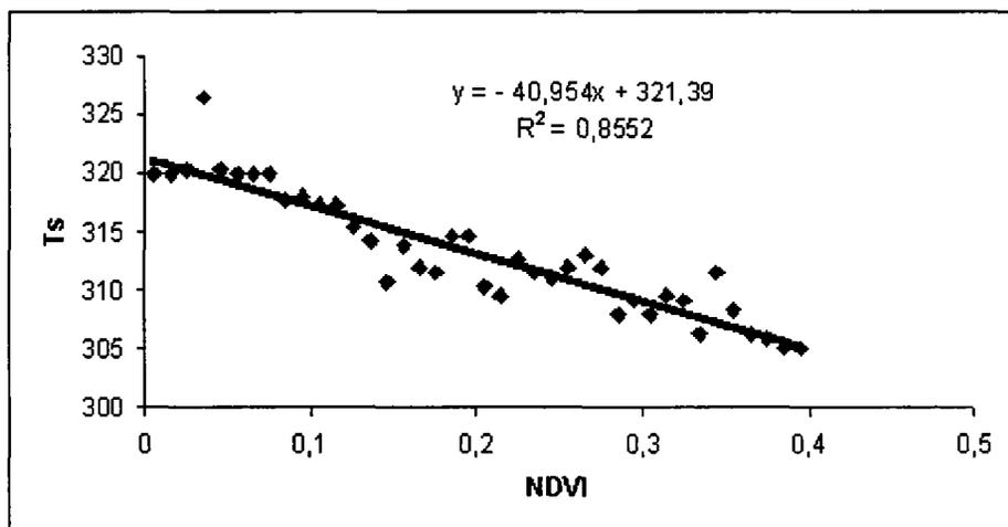
Figure 4. Détermination de la bordure sèche du triangle pour l'estimation de l'indice de sécheresse (TVDI). La valeur maximale de Ts est extraite dans les intervalles de NDVI et la bordure sèche est obtenue par la méthode de régression linéaire.
