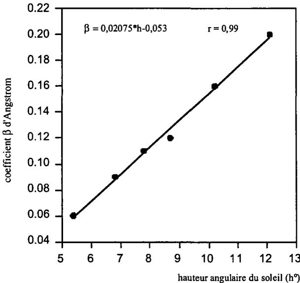
**Figure 1.** Variation du coefficient de trouble atmosphérique  $\beta$  en fonction de la hauteur du lever de soleil mesuré par l'héliographe à la station météorologique de Constantine pour quelques jours de ciel clair sans nuage pour le mois de juin 1986.
