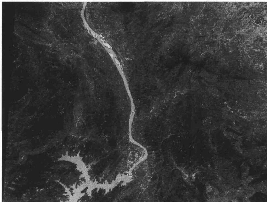
**Figure 2.** Image HRV de SPOT en mode panchromatique de la région de Hoabinh, 21 juin 1990; on peut observer un segment d'une faille normale active de direction N-S à l'est de la vallée de la rivière Noire (interprétation sur la figure 3)
