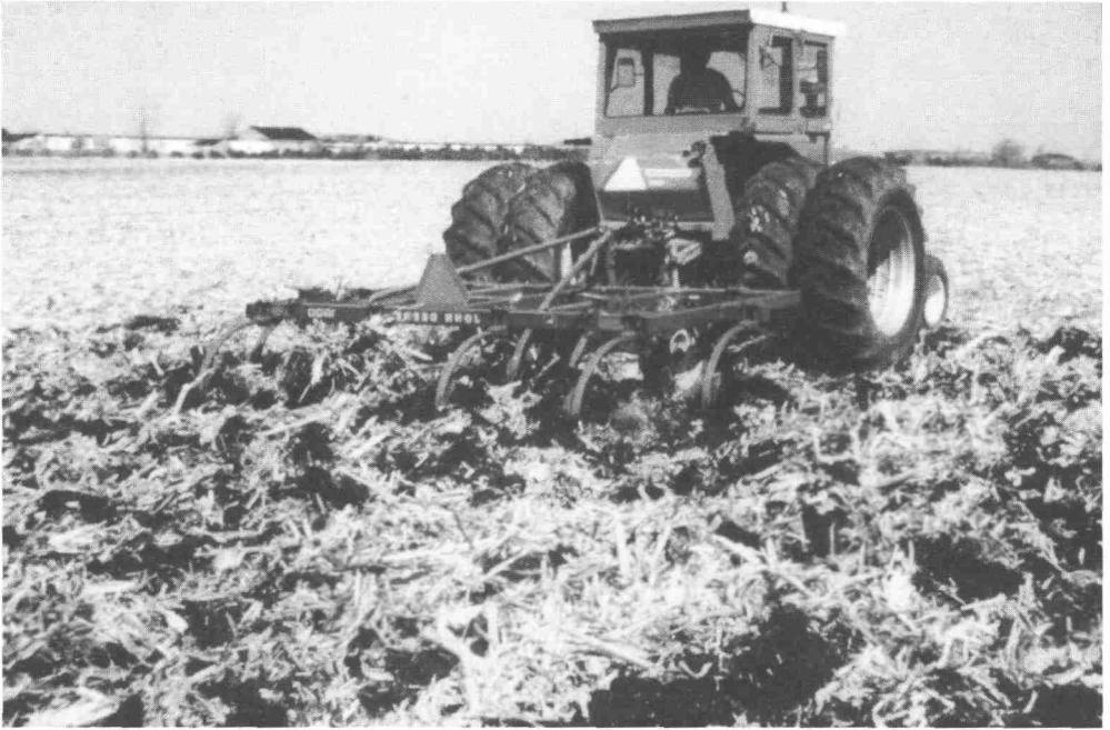
Figure 14.5. Préparation du sol avec le chisel.
